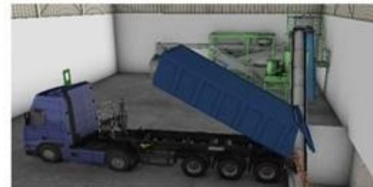
Приемане на отпадъците в междинен бункер, транспортиране с шнекове на секцията за сепарация.
