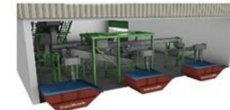
Отбор на инертни материали (пластмаса, стъкло, метал, други), сепариране, почистване и натрупване в контейнери.
